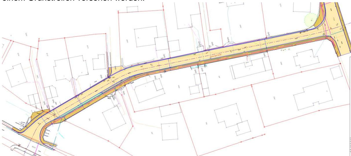
Im Bereich der Starzenbachbrücke ist die Verbreiterung des Gehwegs nicht möglich. Er wird hier lediglich eine Breite von 1,50m aufweisen. Die Fahrbahnbreite wird durchgehend auf 5,00 m reduziert, was aber für den Durchgangsverkehr mit Begegnungsverkehr ausreichend ist.
